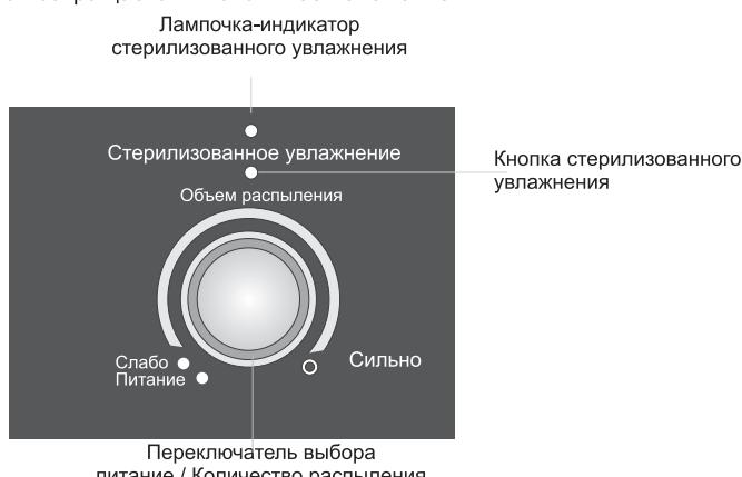
**Переключатель количества распыления:** можно регулировать количество распыления, поворачивая переключатель.
