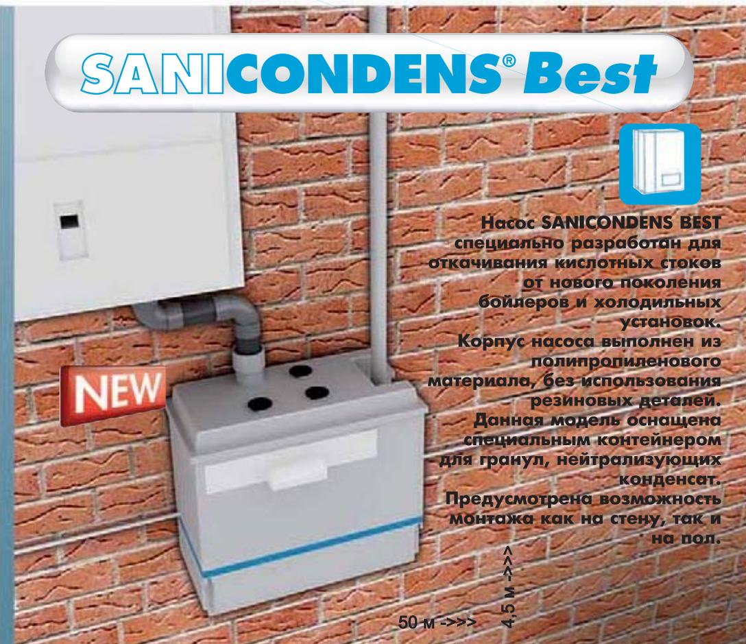
**Насос SANICONDENS BEST специально разработан для откачивания кислотных стоков от нового поколения бойлеров и холодильных установок. Корпус насоса выполнен из полипропиленового материала, без использования резиновых деталей. Данная модель оснащена специальным контейнером для гранул, нейтрализующих конденсат. Предусмотрена возможность монтажа как на стену, так и на пол.**
