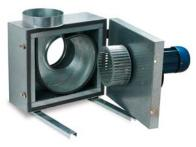
Диаметр патрубков на входе и выходе соответствует стандартным размерам вентиляционных каналов. Патрубки имеют резиновое уплотнение для герметизации соединения с воздуховодами. Вентилятор устанавливается на монтажной несущей раме со встроенными виброгасителями.
