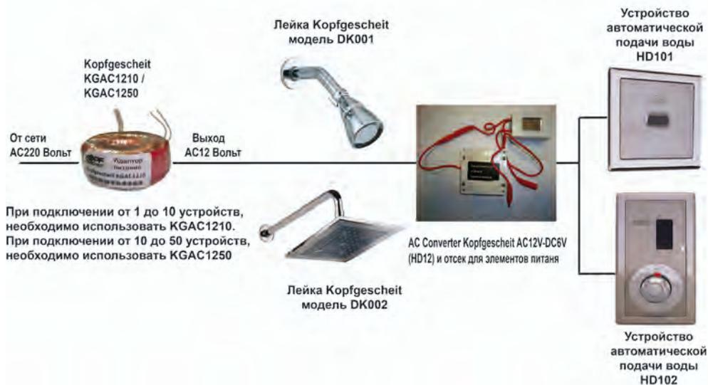
Для моделей Копфгешейт HD101 и HD102 возможны два варианта подключения:
