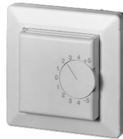
Датчик комнатной температуры с регулированием уставки применяется в системах вентиляции и кондиционирования для контроля температуры воздуха в помещении с возможностью регулирования уставки температуры (-5...+5° С от заданной на контроллере температуры).
