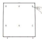
3 При помощи электродрели просверлите отверстия
