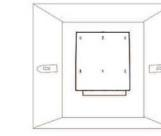
6 Установите рулон полотенец в корпусе устройства, для чего нажмите на рулон, чтобы фиксаторы вошли во втулку рулона.
