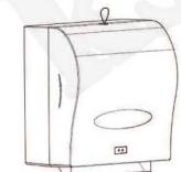
1 При помощи ключа откройте крышку устройства
