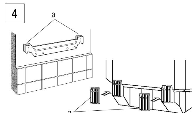
При установке приборов вместимостью 120 и 150 л используйте 2 настенных кронштейна.
