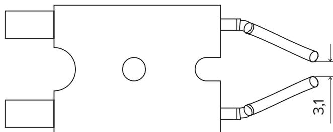
**Рисунок 2** — Рекомендуемый зазор между электродами зажигания
