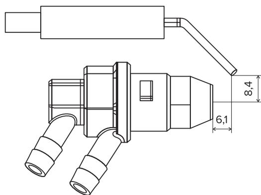
**Рисунок 3** — Рекомендуемый зазор между форсункой и электродами зажигания
