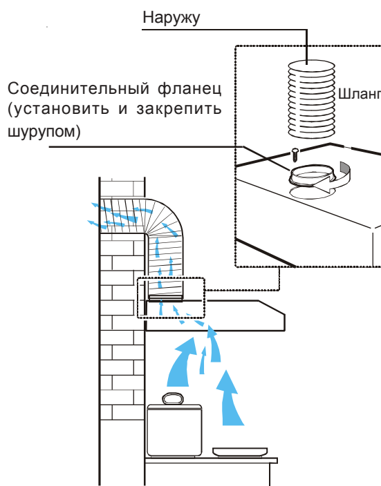
Рис. 1 - Работа прибора в режиме вытяжной вентиляции
