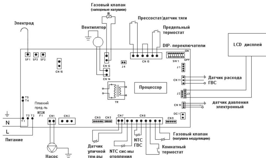
На плате управления используется принцип кодирования при помощи DIP-переключателей (SW1). Для корректной работы котла важно, что бы положения DIP-переключателей соответствовали модификации котла.
