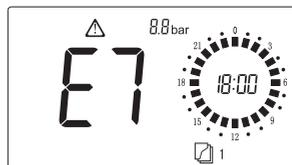
Датчик температуры теплоносителя неисправен.
