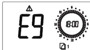
Если по какой-либо причине температура в системе отопления опускается ниже +2 °С, котел выключается и на дисплее появляется код ошибки «E9».
