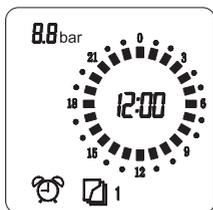
На табло все метки включены (ON) и котел работает в режиме отопления с заявленной температурой теплоносителя.
