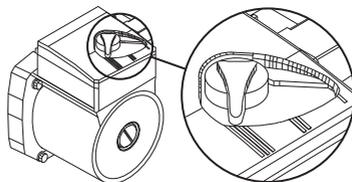
На заводе установлена «III» скорость вращения насоса, что соответствует максимальной производительности.
