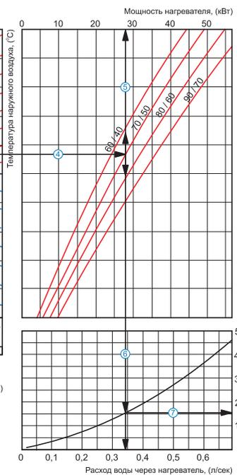
Пример расчета параметров водяного нагревателя:
