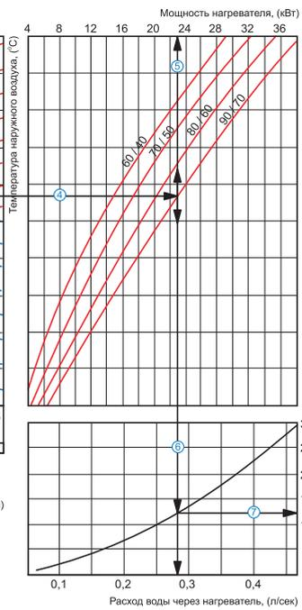
Пример расчета параметров водяного нагревателя:
