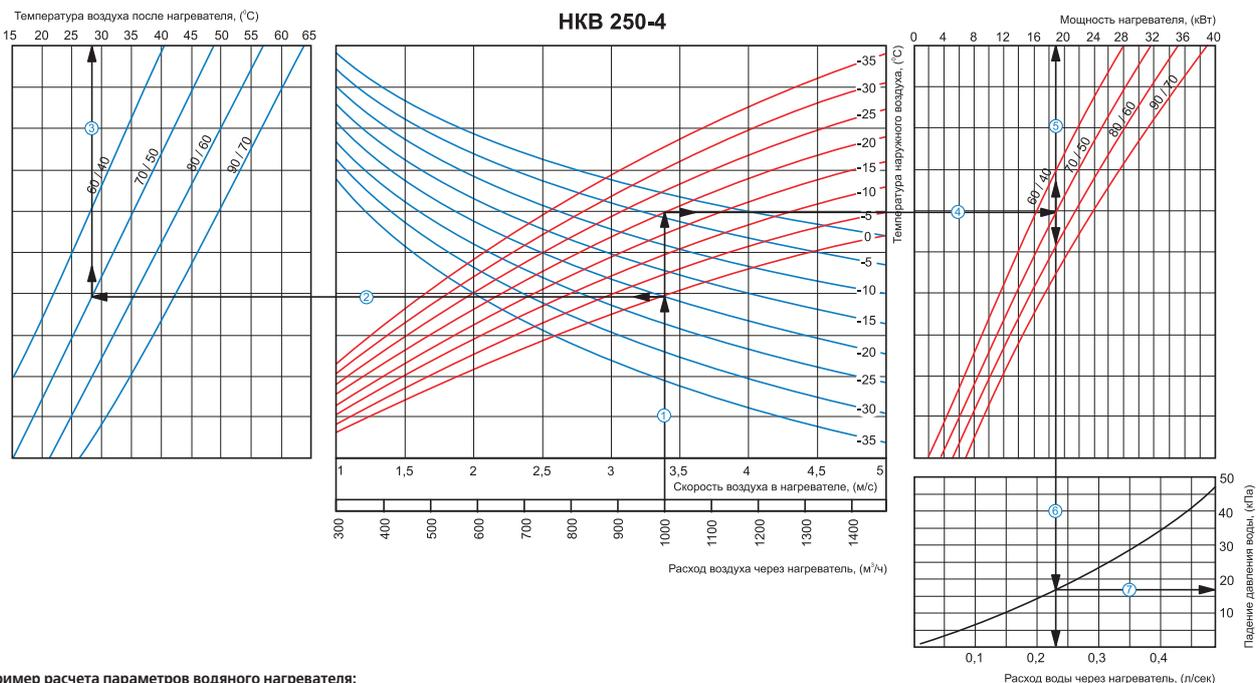
**Пример расчета параметров водяного нагревателя:**
