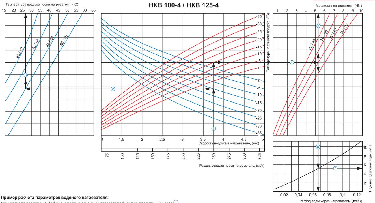
Пример расчета параметров водяного нагревателя:
