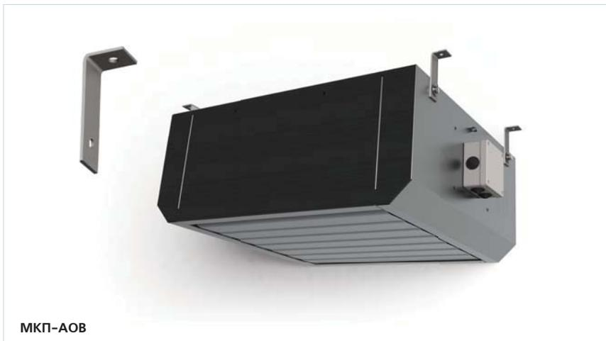
1. Уголки позволяют выполнить горизонтальную установку агрегата с креплением к потолку при помощи монтажных шпилек или цепей. Данный вариант монтажа подходит в том случае, если агрегат работает на нагрев.
