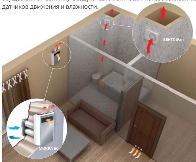
Приточно-вытяжная установка МИКРА 60 монтируется на фасадную стену внутри помещения с минимальной толщиной стены 100 мм.
