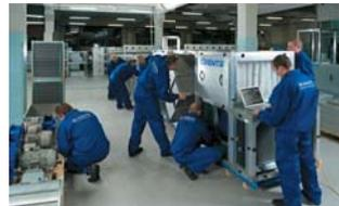
Цех изготовления приточно-вытяжных агрегатов AirVents
