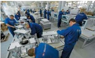
Цех изготовления приточно-вытяжных установок
