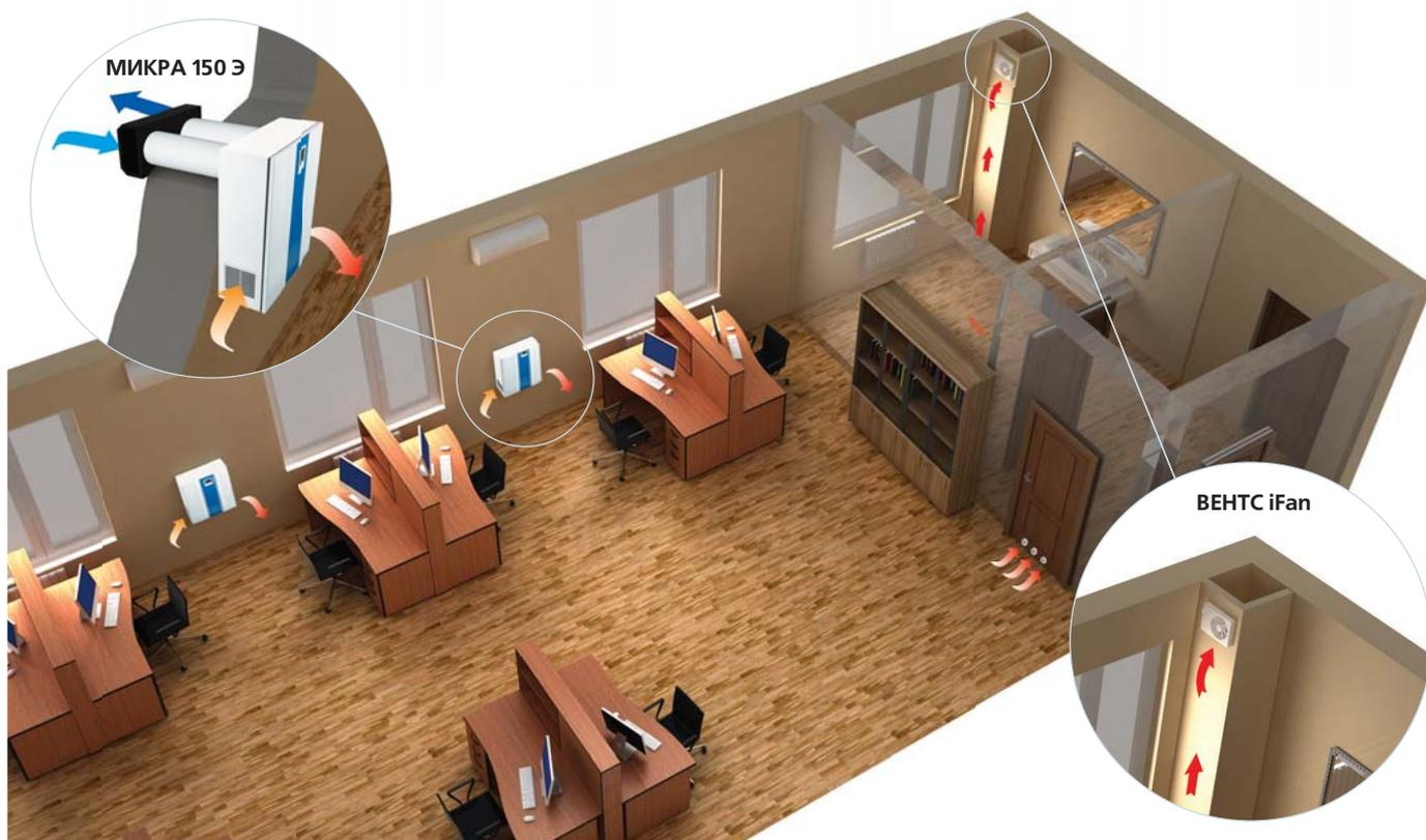
Приточно-вытяжная установка **МИКРА 150 Э** монтируется на фасадную стену внутри помещения с толщиной не менее 100 мм. В начале монтажа, с помощью картонного шаблона, который входит в комплект поставки, на стене размечаются отверстия для воздуховодов. После высверливания отверстий картонный шаблон крепится к стене при помощи дюбелей и шурупов.
